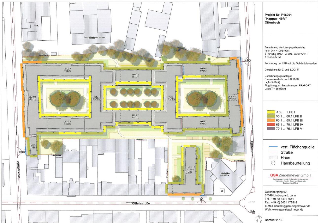
Abbildung 12: Berechnung der Lärmpegelbereiche nach DIN 4109 (Darstellung für 2. OG und 3. OG ff.) GSA Ziegelmeyer GmbH, Limburg, 30.12.2016
